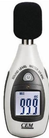
Un **sonomètre** est un instrument destiné à mesurer le niveau de pression acoustique, une grandeur physique liée au volume sonore.
