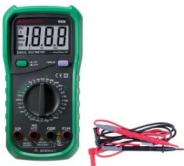
Le **multimètre** est un appareil qui mesure trois grandeurs :
