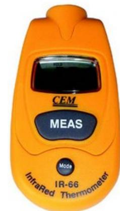
Un **thermomètre infrarouge** est un instrument de mesure de la température de surface d'un objet.
