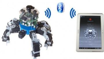
Il modifie son comportement en fonction des informations transmises par ses **capteurs** et **un signal extérieur** (signal bluetooth d'un smartphone).
