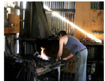
L'acier est forgé. Il s'agit de l'ensemble des techniques consistant à appliquer une force mécanique sur une pièce de métal, à froid ou à chaud, afin de déformer la pièce pour obtenir la forme voulue.
