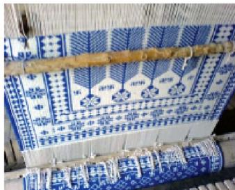
Le tissu est obtenu par le tissage qui est le résultat de l'entrecroisement, de fils disposés dans le sens de la chaîne et de fils disposés, perpendiculairement aux fils de chaîne, dans le sens de la trame.
